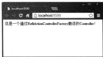
图 3-8 利用注册的 ReflectedControllerFactory 激活 Controller
